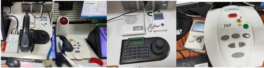
操作台治疗系统控制台及钥匙锁（操作台急停按钮）
